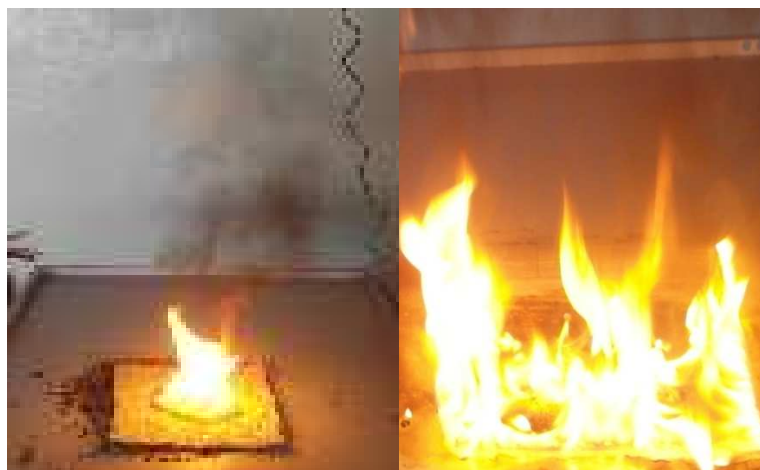
Obrázok 6 Odhorievanie benzínu z koberca 1 a PVC podlahovej krytiny
