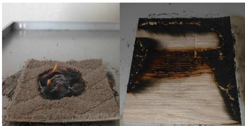
Obrázok 7 Porovnanie odhorenia na koberci a PVC podlahovej krytine
