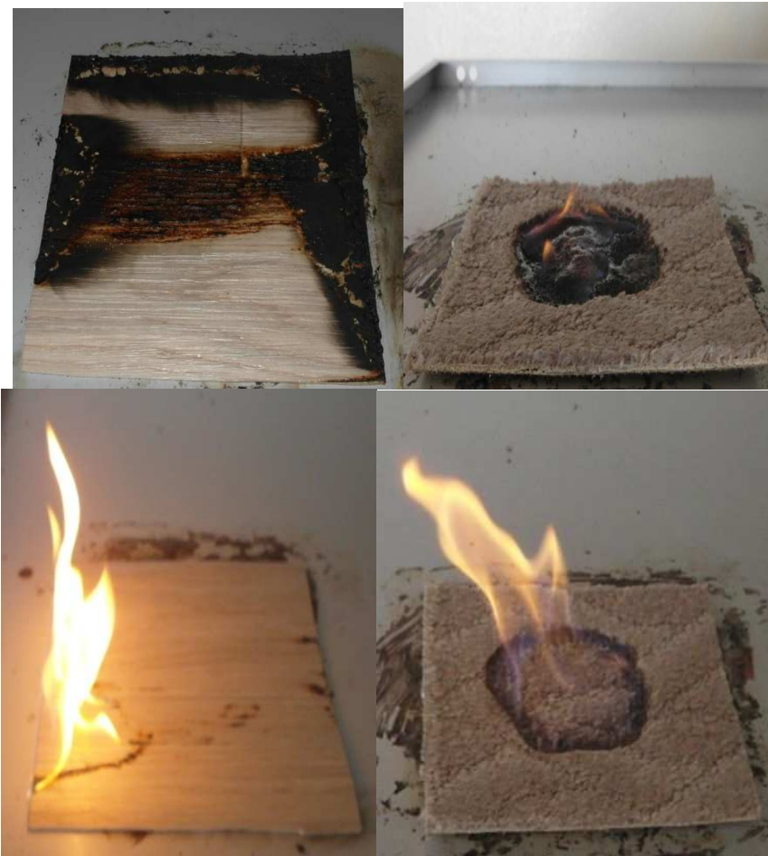
Obrázok 5 Odhorievanie denaturovaného liehu z koberca 1 a PVC podlahovej krytiny
