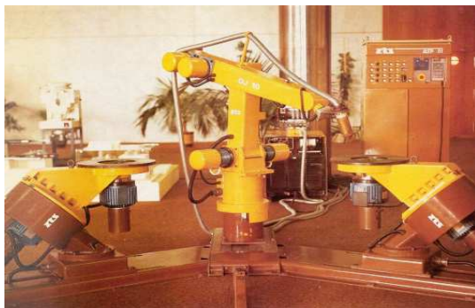
Obr. 5 Robotizované plazmové pracovisko [8]
