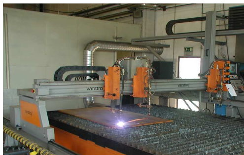
Obr. 7 Plazmové pracovisko s pevným stolom [7]
