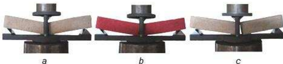
Obr. 9 – Porušenie skúšobného hranolčeka v ohybe a, s potravinárskou želatínou, sušený v peci, b, s farmaceutickou želatínou, sušený v peci, c, so želatínou Weishardt, sušený na vzduchu.
