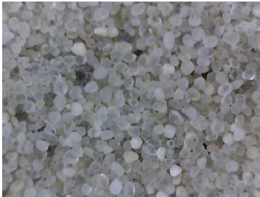
Obr. 1 - Ostrivo - kremenný piesok frakcia 0,315 - 0,400 mm (zväčšenie 40x).
