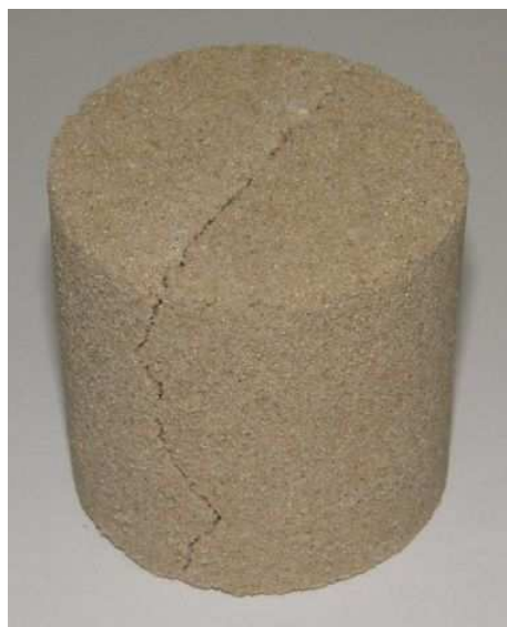
Obr. 2 - Skúšobný valček po stanovení pevnosti v strihu.
