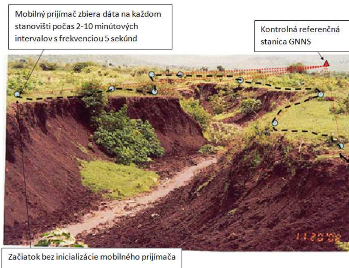
Obr. 3 Sledovanie rozsahu erózie pomocou rýchlej statickej metódy. Trojuholník označuje referenčnú stanicu, zatiaľ čo body označujú pozície observované mobilným prijímačom
