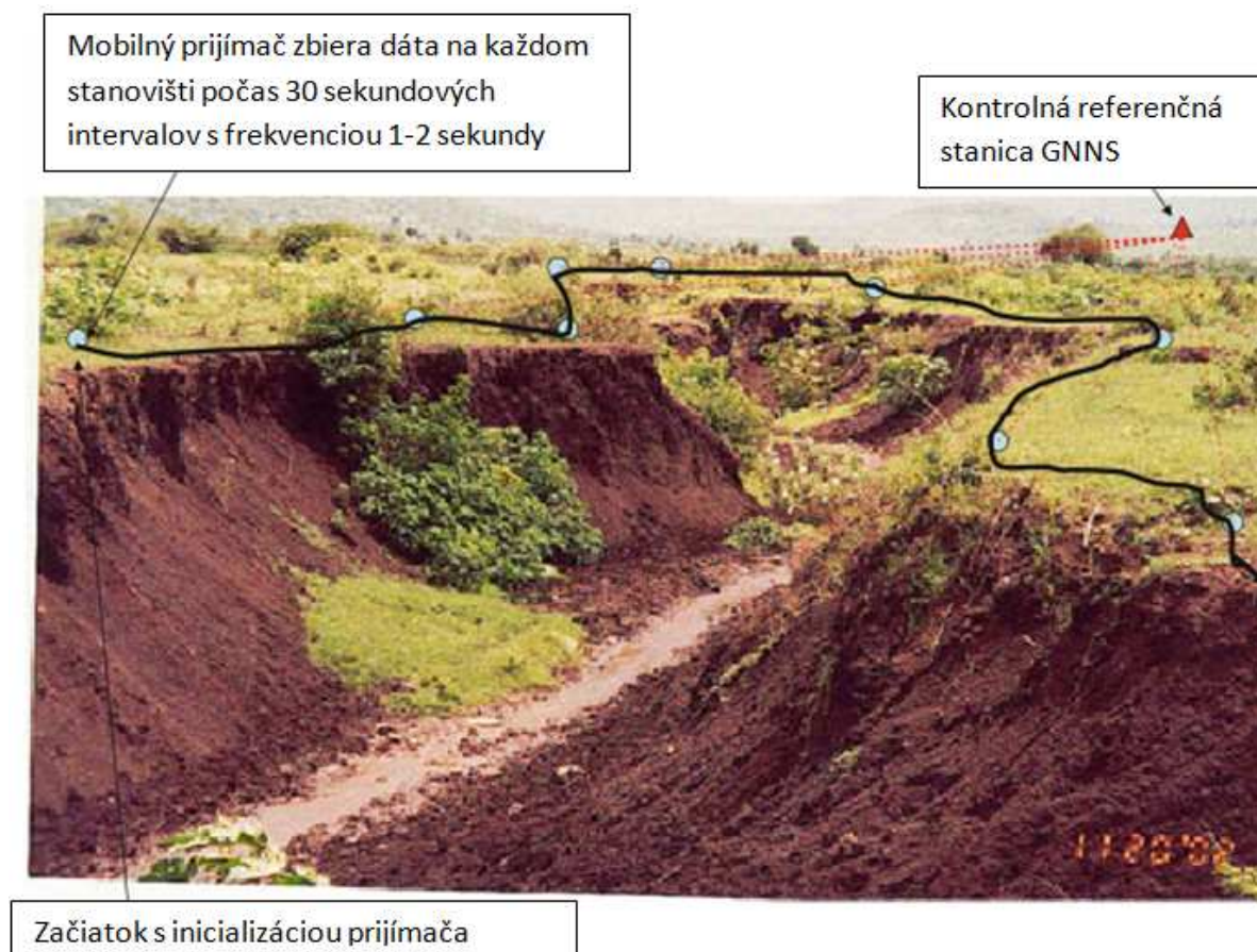
Obr. 4 Monitorovanie rozsahu erózie pomocou stop-and-go metódy. Trojuholník označuje kontrolné stanovisko, zatiaľ čo body označujú pozície observované mobilným prijímačom. Inicializácia musí byť vykonaná na prvom stanovišti naviazanosti na štyri alebo viac spoločných satelitov musí byť udržiavaná po dobu merania.
