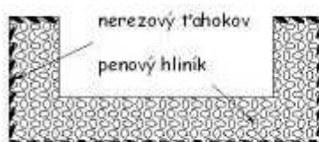
Obr. 5 Profil z penového hliníka vystužený ťahokovom [1]
