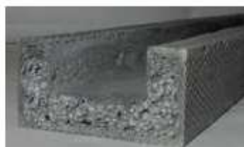
Obr. 5 Profil z penového hliníka vystužený ťahokovom [1]
