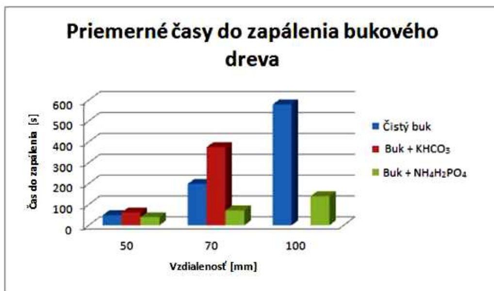
Obr. 3: Priemerné časy do zapálenia bukového dreva
