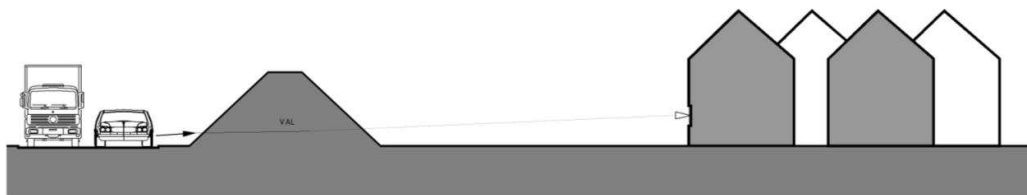
Obr. 3 Schematické znázornenie zemného valu pri zástavbe.
