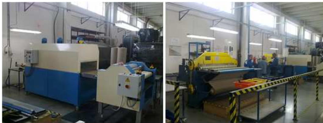
Obr. 2 Pracovisko perforovania a podlepovania kože [8].
