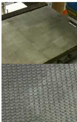
Obr.7 Stav plechu po odmastení a detail odmastenej časti plechu
