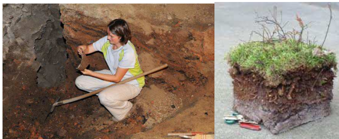
Obr. 2: Schéma kopanej sondy, odber porušenej vzorky a pôdny monolit
