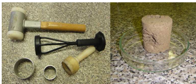
Obr. 3: Kubienove rámčeky a Kopeckého valčeky pre odber neporušených vzoriek pôdy
