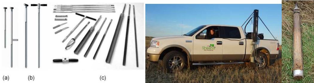
Obr.5: Sondovacie tyče(a) s násťapňým stupňom, b) žliabkový vzorkovač, c) sada pre odber porušenej vzorky) a baranidlová sonda pre odber neporušenej vzorky
