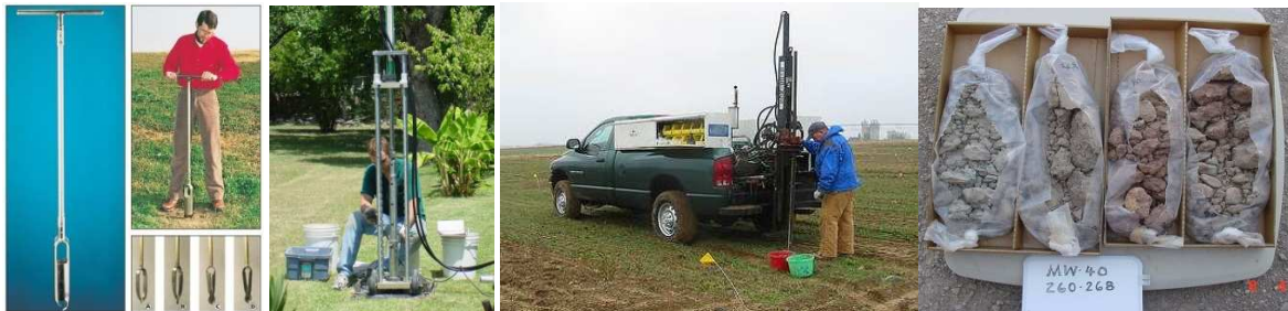
Obr. 4: Ručné, poloautomatické a automatické vŕtacie zariadenie pre odber porušených vzoriek
