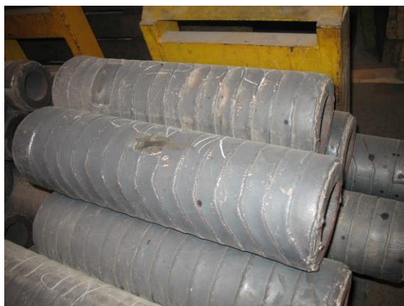
Obr. 5 Renovované valce kontilíatia - metódou 121 STN EN ISO 4063
