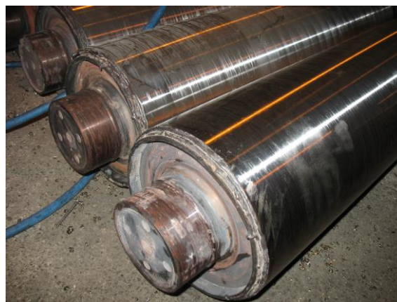
Obr. 6 Renovované valce kontilíatie po opravovaní
