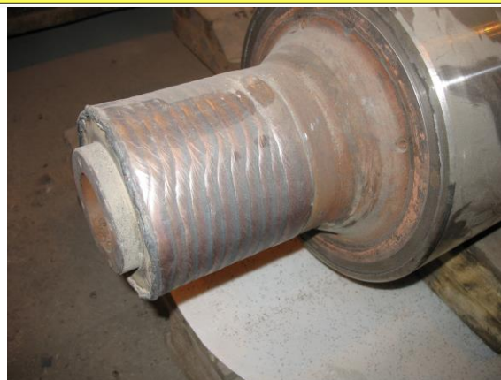
Obr. 4 Renovovaný čep valca metódou 121 STN EN ISO 4063
