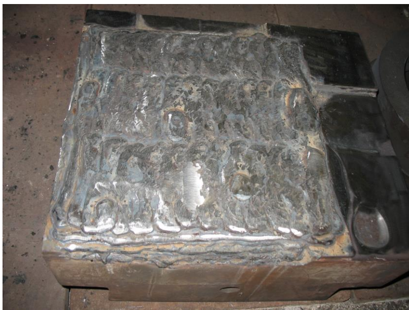
Obr. 1 Renovácia rovinných plôch – zápustka naváraná metódou 136 STN EN ISO 4063
