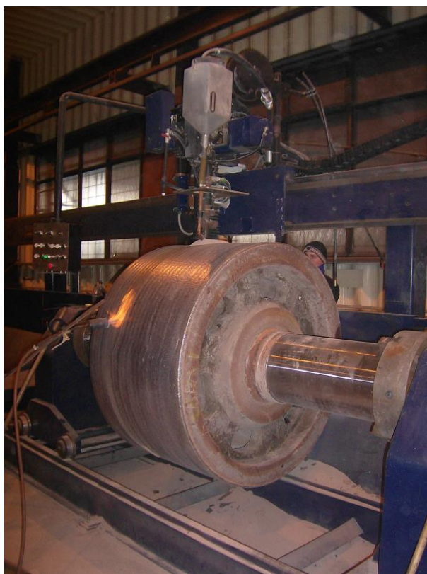
Obr. 2 Renovácia rotačných plôch – naváranie kladky metódou 121 STN EN ISO 4063
