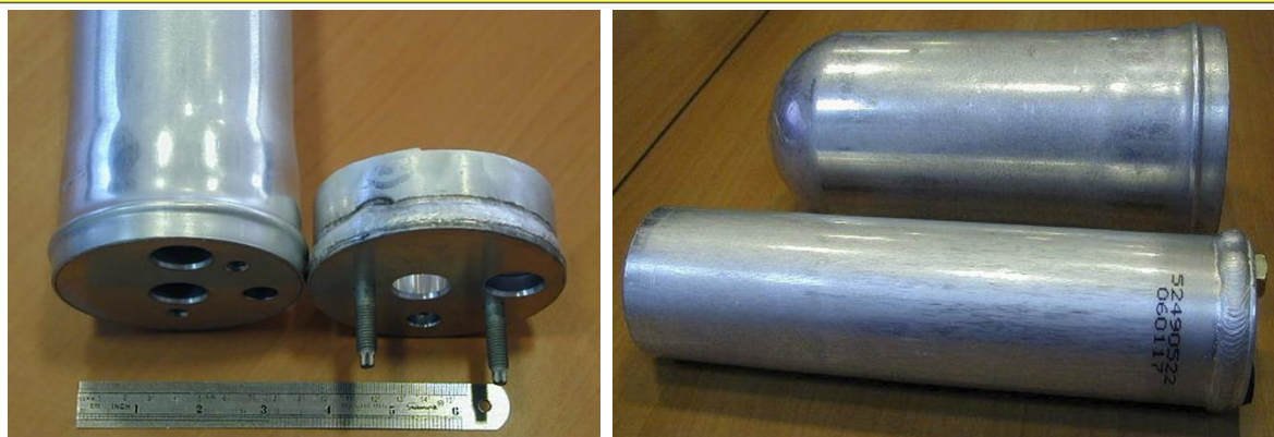
Obr. 9 - Porovnanie zvarov vyhotovených MPW a GMAW [16]
