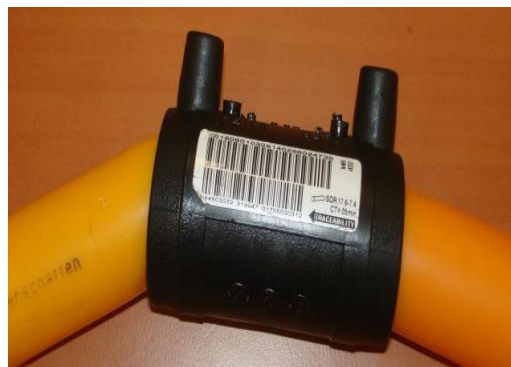
Obr. 12 - Príklad chyby pri vizuálnej kontrole – suosovosť
