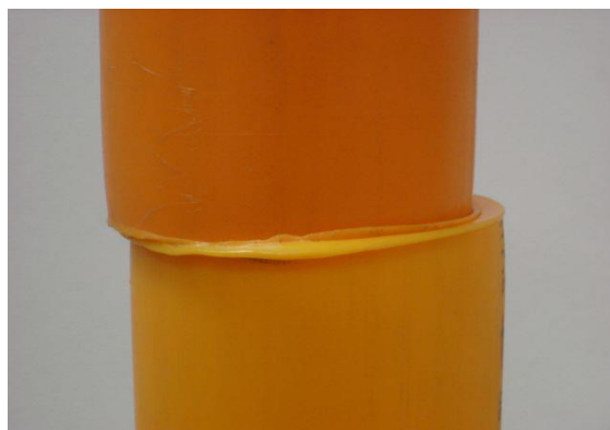
Obr. 10 - Príklad chyby pri vizuálnej kontrole – presadenie rúr
