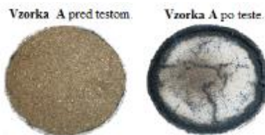
Obr. 3 Vzorka prachu peliet pred a po teste na kónickom kalorimetri.
