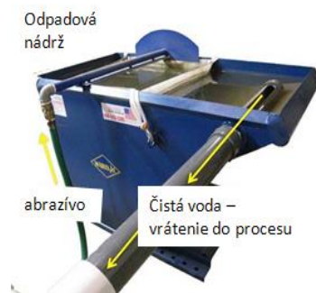
Obr.7:Zariadenie WARDJet AROS na recykláciu vody a abrazíva [15]
