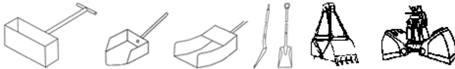
Obr. 1 Nádoba na odber vzorky z padajúceho toku, rôzne typy lopát a drapáky [3]
