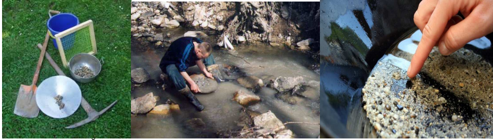
Obr. 2 Šlichovací tanier, spôsob šlichovania a usadeniny na dne taniera [9, 10]
