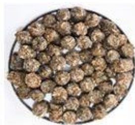
Obr. 3 Vzorka A – palety vyrobené z ihličnatých drevín s trávou
