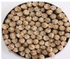
Obr. 5 Vzorka C - pelety vyrobené z ihličnatých drevín bez kôry
