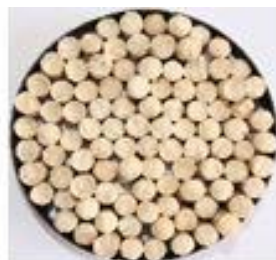
Obr. 4 Vzorka B - palety vyrobené z ihličnatých drevín s kôrou
