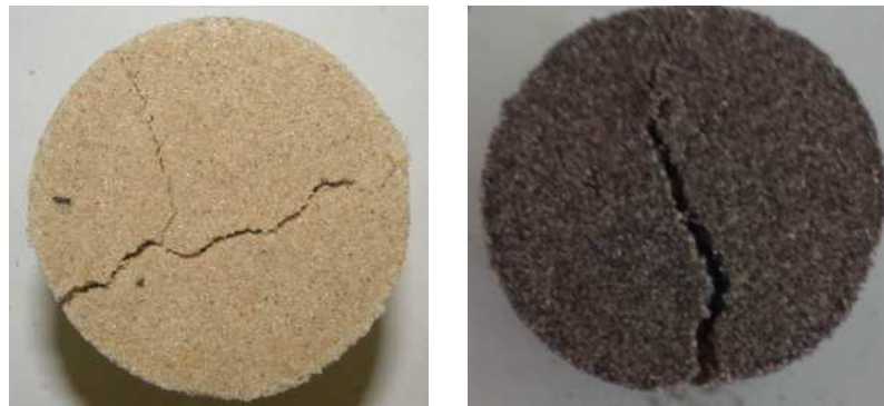
Obr. 2 Porušené skúšobné valčeky po meraní pevnostných vlastností, pohľad zhora. Vľavo po meraní pevnosti v tlaku, pôvodná zmes. Vpravo po meraní pevnosti v rozštepe, regenerovaná zmes.
