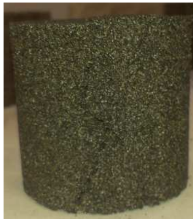
Obr. 1 Skúšobný valček z regenerovanej formovacej zmesi
