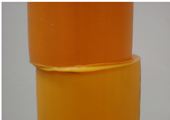
Obr. č. 10 Príklad chyby pri vizuálnej kontrole – presadenie rúr
