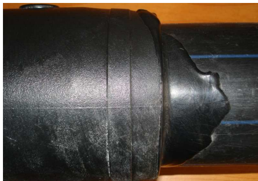
Obr. č. 11 Príklad chyby pri vizuálnej kontrole – pretečenie elektrotvarovky
