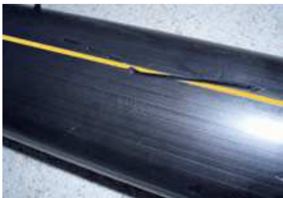
Obr. č.4 vznik trhliny na PE potrubia
