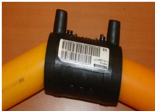
Obr. č. 12 Príklad chyby pri vizuálnej kontrole – suosovosť
