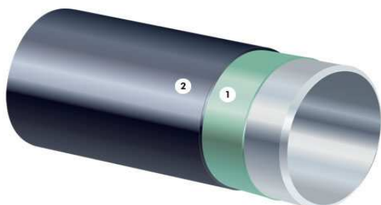
Obr.9 Povrchová ochrana PRITEC® [1]
