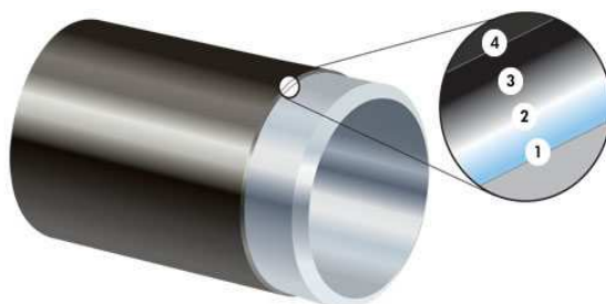
Obr.8 Povrchová ochrana HPCC - SE [1]
