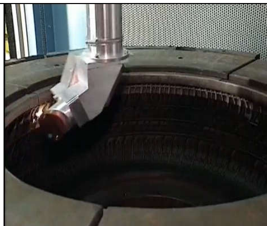
Obr. 2 Strojný spôsob čistenia formy laserovým lúčom
