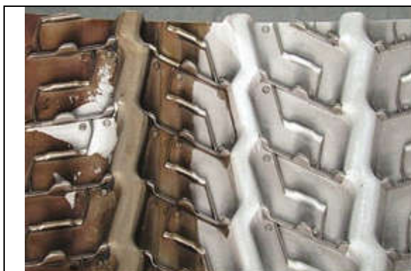
Obr. 3 Čistenie formy, plocha pred a po vyčistení
