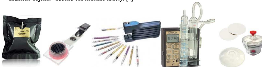
Obr. 1: Vzorkovací vak, pasívny a aktívny vzorkovač s tuhým sorbentom, impinger a filtre
