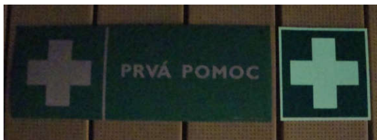
Obr. 14 Bezpečnostná značka „Prvá pomoc“ vyrobená z PVC a fotoluminiscenčné bezpečnostné značenie „Miesta prvej pomoci“ za šera.
