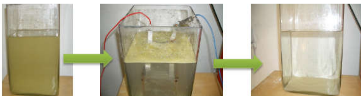
Obr. 13 Vzorke vody Obr. 14 Flotát na vzorke vody Obr. 15 Voda po elektroflotácii
