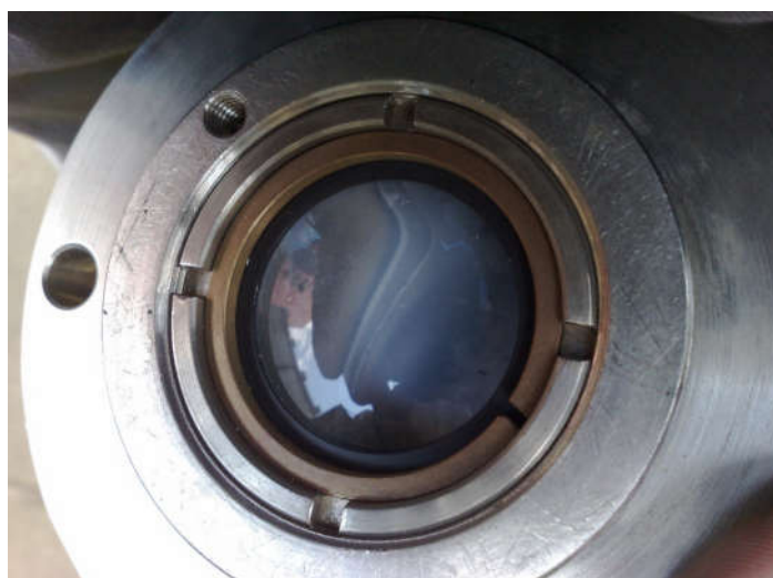
Obr. 8 Narušenie povrchu hlavnej šošovky fluorovodíkom v prefukovom vzduchu
