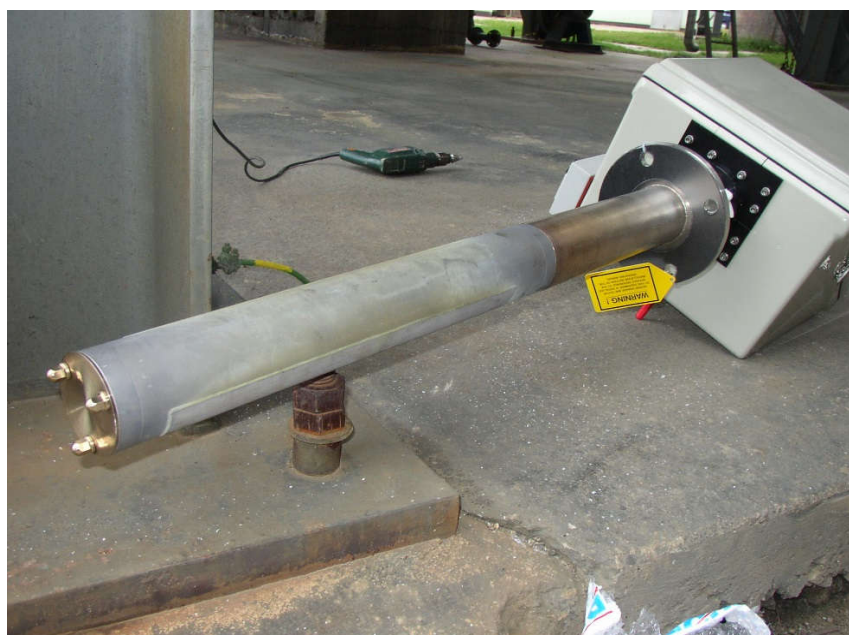
Obr. 6 Pohľad na meraciu a oddeľovaciu časť sondy OHU Procal
