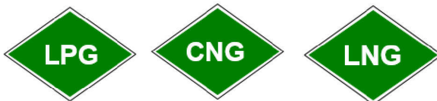
Obr.1: Označenie pohonov na LPG, CNG a LNG na vozidle [5].
