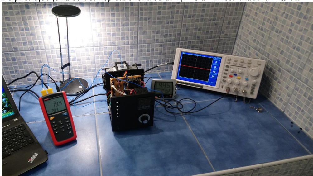
Obr. 8 Rozloženie zariadení testu chladiča GSC-1.
