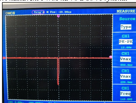
Obr. 16 Priebeh signálu PWM pri nastavení PWM na 90 a 100 % výkonu.
