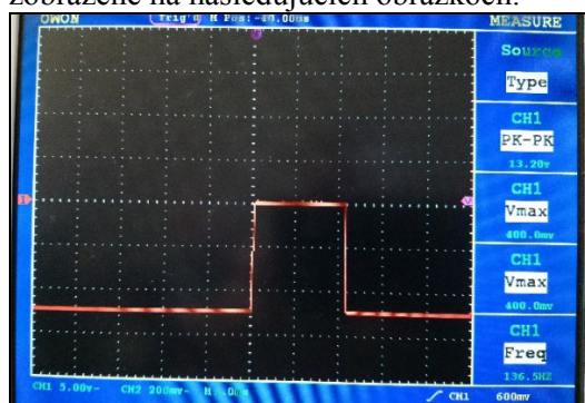
Obr. 13 Priebeh signálu PWM pri nastavení PWM na 30 a 40 % výkonu.
