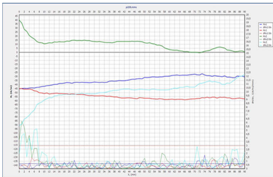
Obr. 8 – Příklad svaru, kde nebyly nalezeny zóny koncentrace napětí [15].
