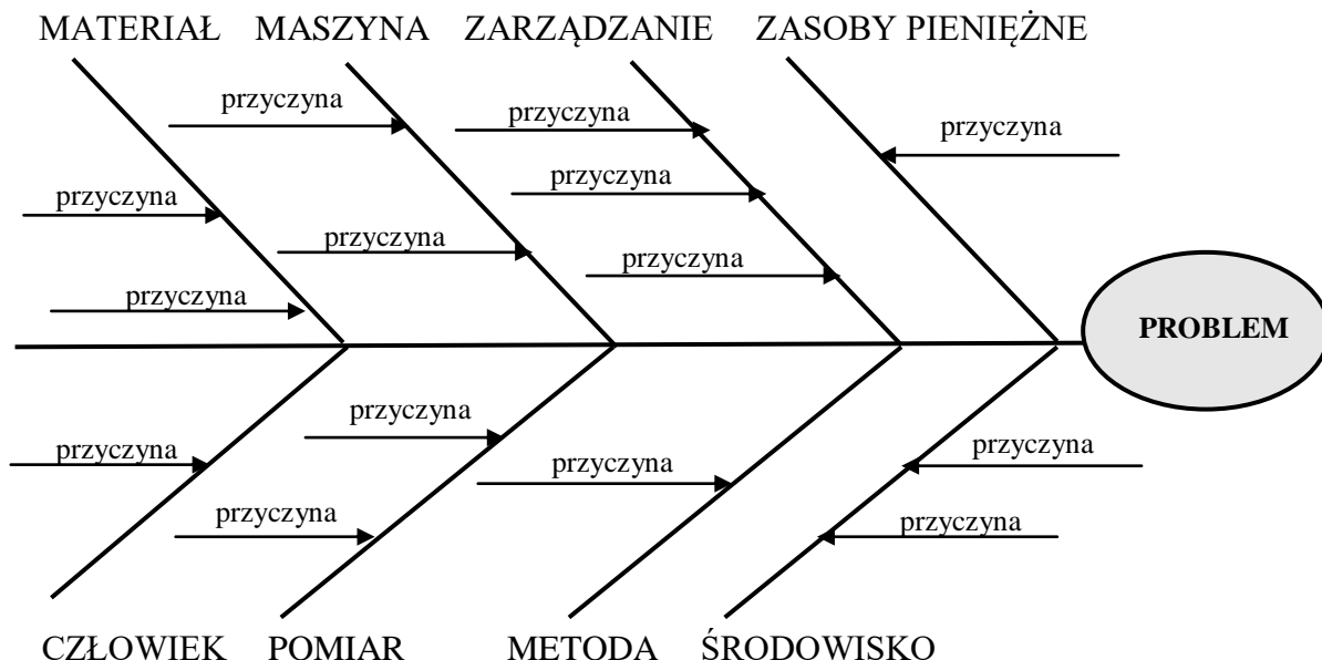
Rys. 2. Przykładowy schemat sposobu opracowania diagramu Ishikawy. Opracowanie własne na podstawie [11]
