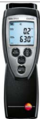
Obr.1 TESTO 315 – 3 CO / CO – prístroj použitý na meranie CO 2
