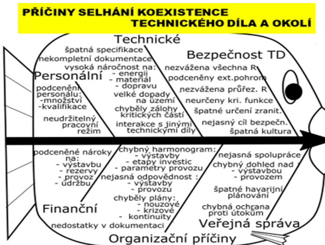
Obr. 2. Příčiny selhání koexistence technického díla a jeho okolí z důvodu chybného výběru typu technického díla nebo chybného umístění technického díla do území.
