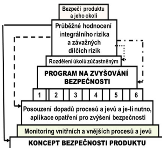
Obr. 10. Model řízení bezpečnosti komplexního kritického objektu v čase. Procesy: 1- koncepce a řízení; 2 - administrativní postupy; 3 - technické záležitosti; 4 - vnější spolupráce; 5 - nouzová připravenost; a 6 - dokumentace a šetření havárií[1].
