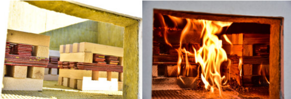
Obr. 3 Spôsob uloženia horľavých materiálov
