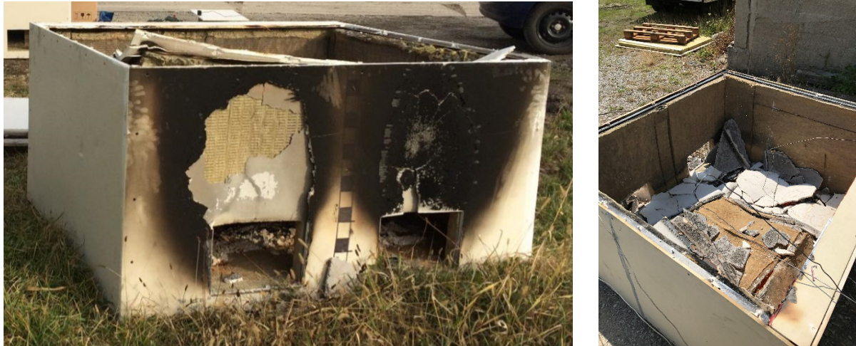
Obr. 2 Účinky tepla a plameňa na celistvosť modelu
