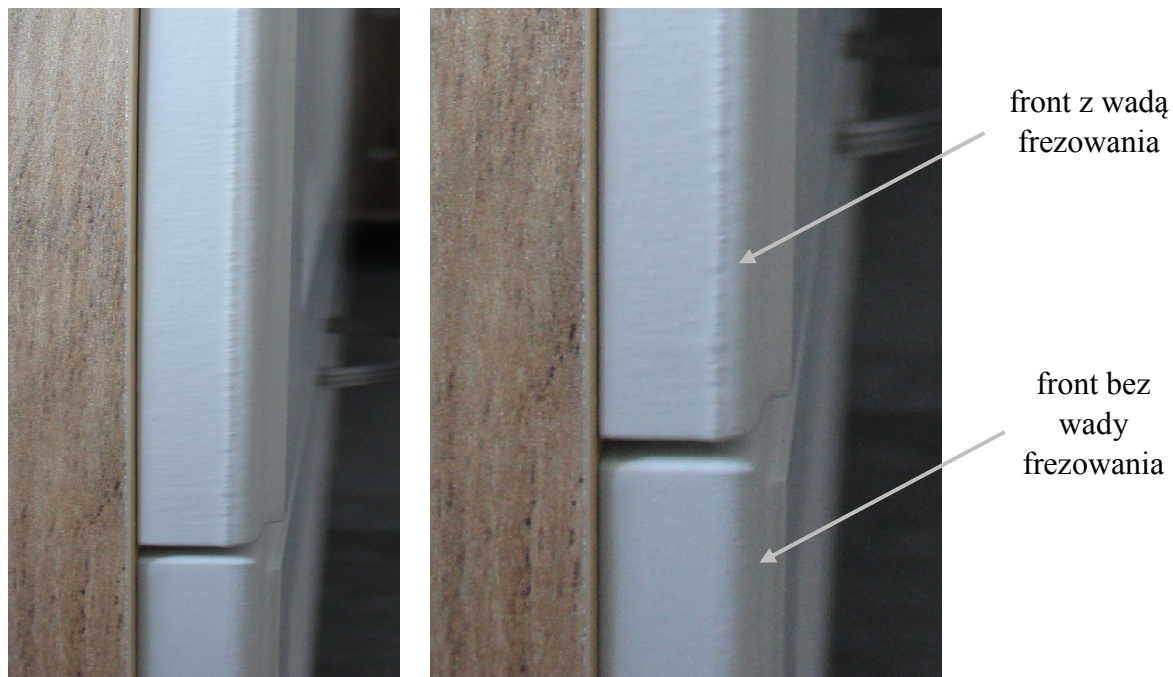
Rysunek 2. Przykład wady frezowania na froncie meblowym.
