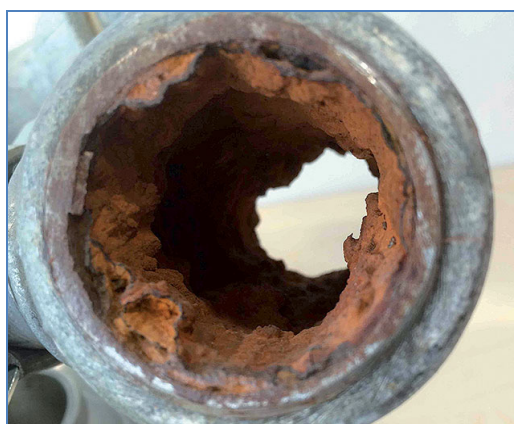
Obrázok 5 - Vodný kameň na ohrievacej špirále (vľavo) a na stenách potrubia (vpravo)
