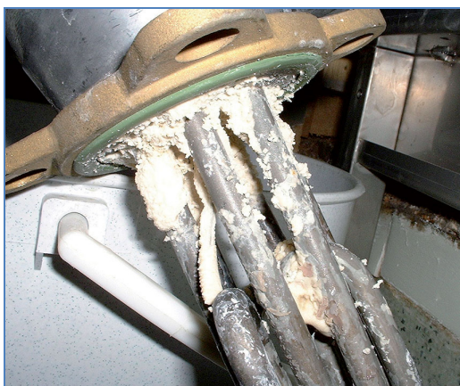
Obrázok 5 - Vodný kameň na ohrievacej špirále (vľavo) a na stenách potrubia (vpravo)
