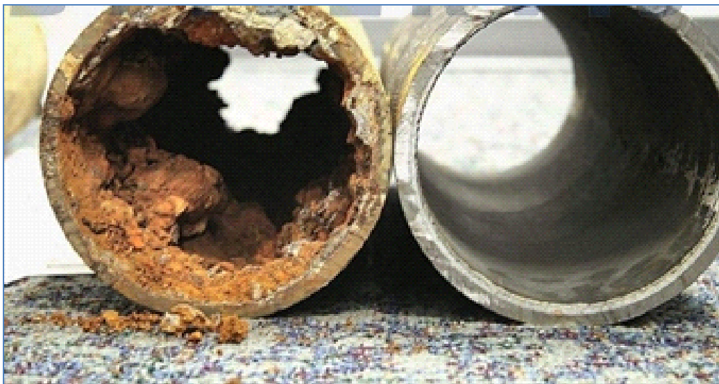
Obrázok 3 - Rozdiel medzi starým a novým potrubím na vodu [41]
