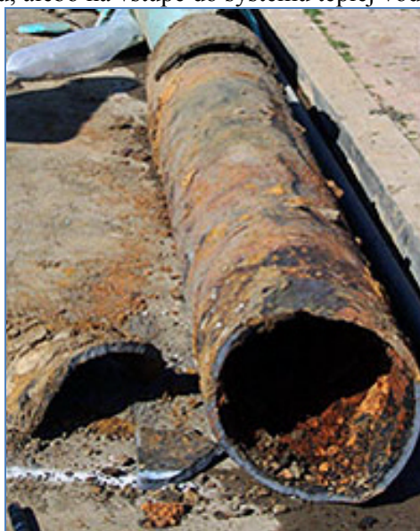
Obrázok 1 - Výsledok agresívneho pôsobenia vody na potrubie
