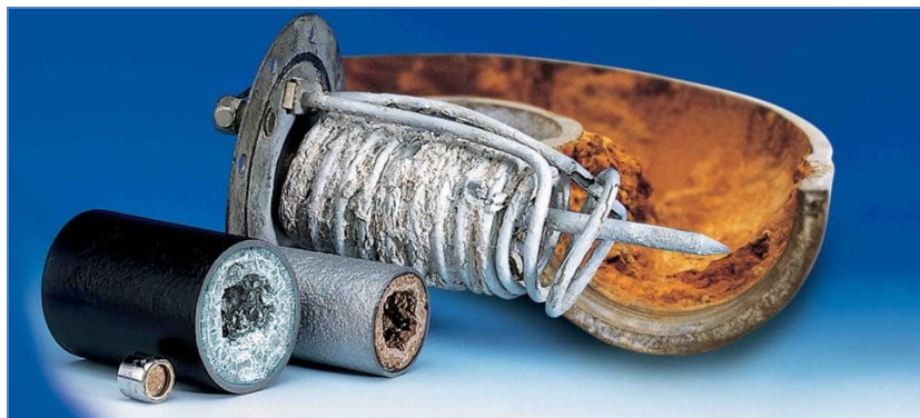
Obrázok 3 - Vodný kameň na ohrievacej špirále a na stenách potrubia [12]
