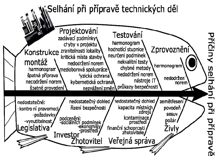
Obr. 6 - Příčiny selhání koexistence SKFS a jeho okolí z důvodu nedostatků či chyb při projektování, zhotovení a spouštění technického díla do provozu
