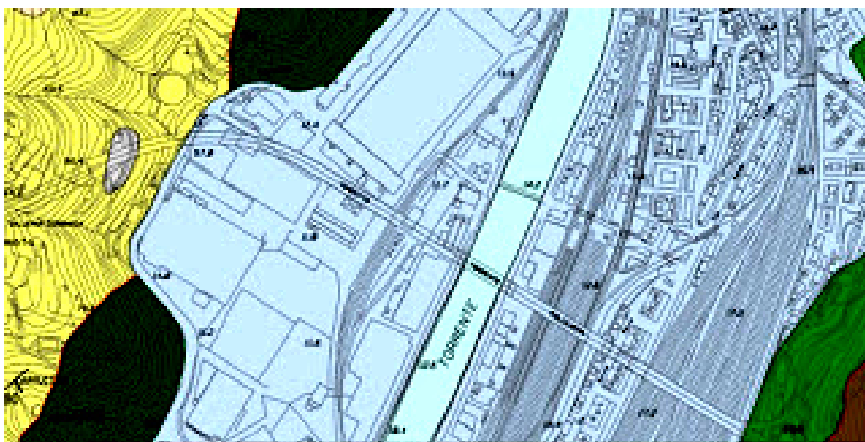
Obr. 4 - Geologické podloží, šedomodrá – naplavené usazeniny, zelena – prachovec [3]
