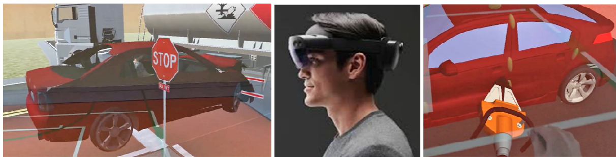
Obr. 4- Riešenie dopravnej nehody motorového vozidla s cisternou prepravujúcou nebezpečnú chemickú látku na vyvíjanom zariadení FightARs (vpravo) s využitím okuliarov HoloLens 2 (uprostred) a simulácia používania vyslobodzovacieho zariadenia pri vyslobodzovaní zranenej osoby (vpravo) z motorového vozidla. (Zdroj: https://www.microsoft.com/en-gb/hololens )
