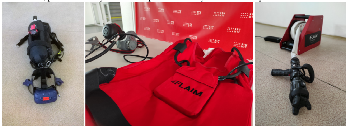
Obr. 5 Použitý tréningový zariadenie VR s príslušenstvom – náhlavná súprava s atarpou autonómneho dýchacieho prístroja (vľavo), polomaska virtuálneho dýchacieho prístroja s tepelnou vestou (uprostred) a prúdica s hadicou so spätnou rázovou silou (vpravo) imitujúcou záťaž respondentu sálavým teplom pri vnútorných požiaroch. (Foto: Veronika Kvorková)
