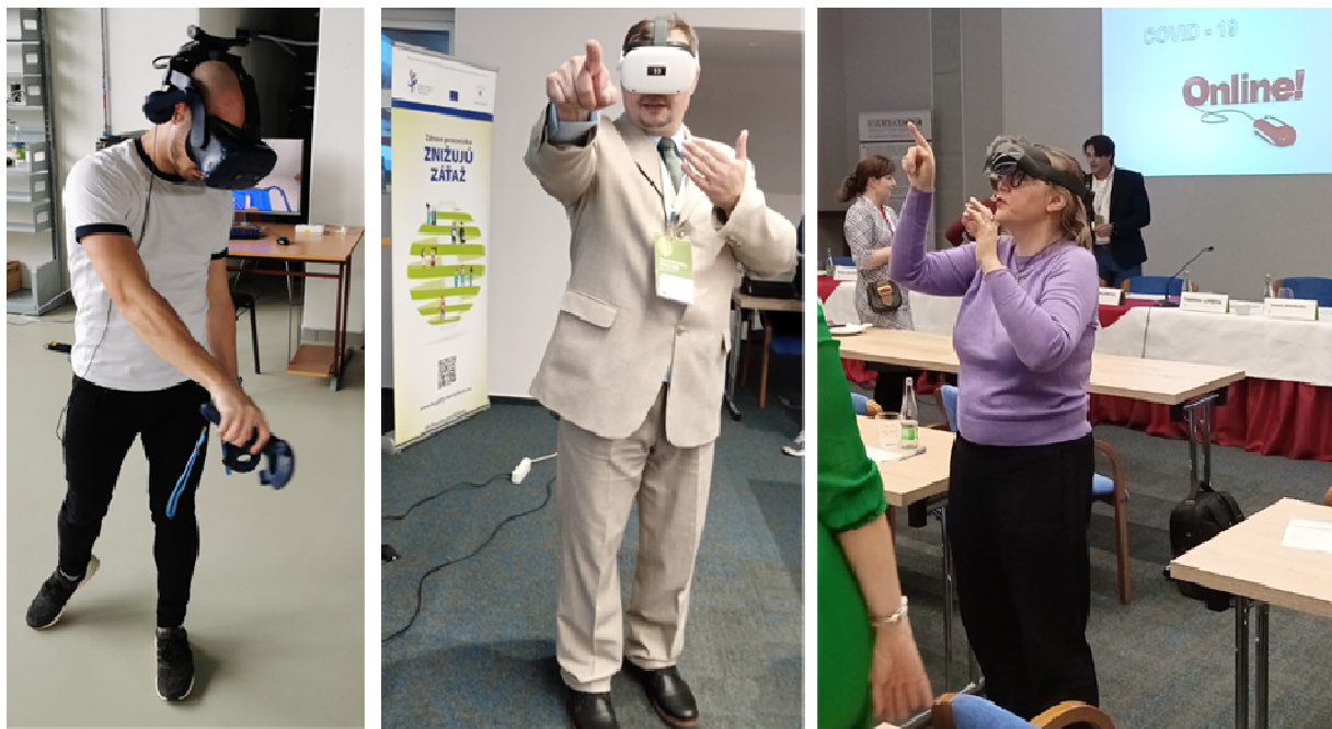
Obr. 1 - Náhlavná súprava VR s ovládačmi (vľavo), náhlavná súprava VR, ktorá umožňuje ovládanie rukou a okuliare HoloLens 2 pre využívanie MR ovládanej rukou.
