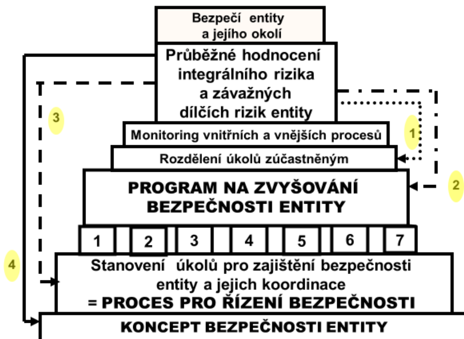
Obr.5. Procesní model řízení bezpečnosti entity v čase. Procesy: 1- koncepce a řízení; 2 - administrativní po-stupy; 3 - technické záležitosti (technická problematika entity a jejího okolí); 4 - vnější spolupráce; 5 - nouzová připravenost; 6 - dokumentace a šetření havárií; a 7 - zabezpečení entity – zpracováno dle [15].
