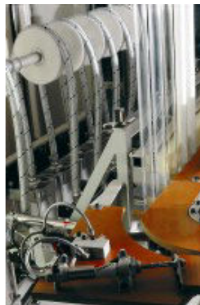
Obr. 5 Vyfúknutie fluorescenčného prášku z trubice
