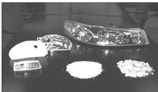
Obr. 2 Príklady recyklačných frakcií plastových svetlometov vozidla
