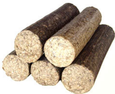
Obr. 6 Výlisky vytvorené piestom na mechanickom lise
