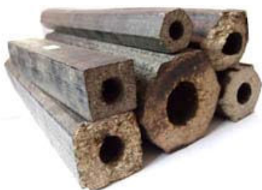
Obr. 8 Vylisky vytvorené lisovacou závitovkou
