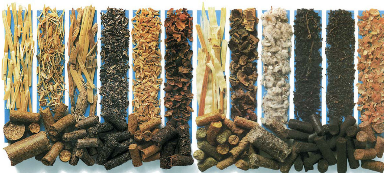
Obr. 3 Výlisky z rôznych druhov materiálov
