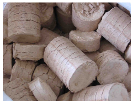
Obr. 7 Štruktúra výlisku - poruchy
