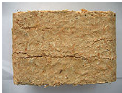
Obr. 5 Štruktúra výlisku - poruchy
